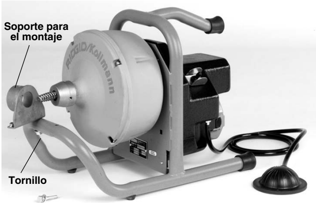
Figura 17 – Soporte para el montaje en posición ABIERTA, lo cual permite acceder al tambor
