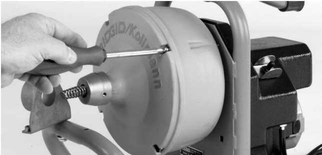
Figura 18 – Afloje los 4 tornillos unas 3 vueltas completas pero no los quite
