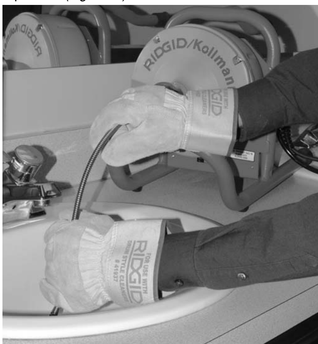
Figure 11 – Avancement manuel du câble
