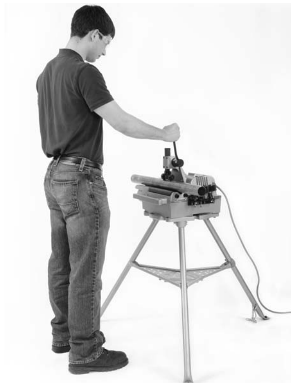
Figura 10 – Corte del tubo
