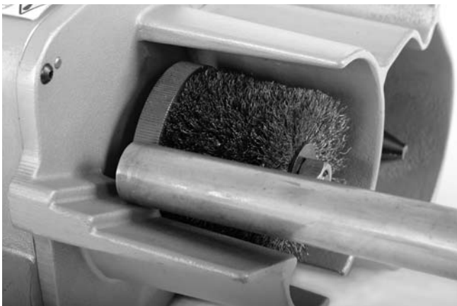
Figura 12 – Eliminación de rebabas del exterior del tubo
