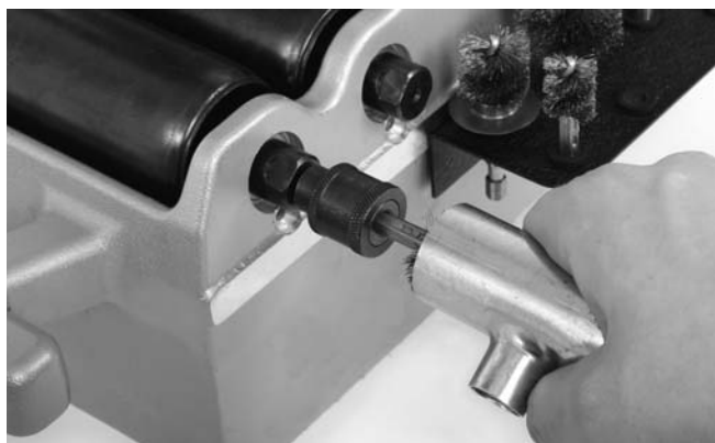
Figura 14 – Limpieza del interior de un acoplamiento
