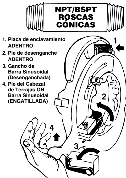
Figura 11 – Colocación de los cabezales de terrajas de autoapertura nos. 714 o 914 para roscas NPT ó BSPT
