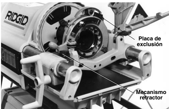
Figura 14 – Colocación de la placa de exclusión para roscas cónicas NPT/BSPT
