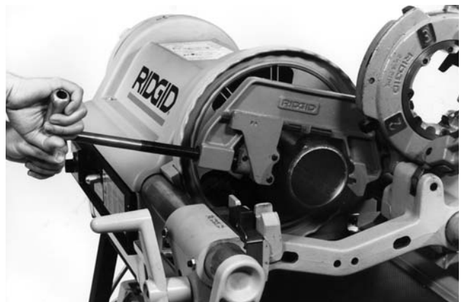
Figure 6 – Utilisation du coupe-tubes N° 764
