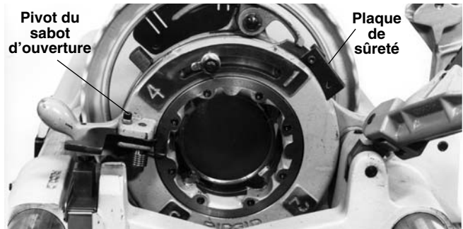
Figure 16 – Positionnement de la plaque de sûreté pour filetage droit NPSM/BSPP
