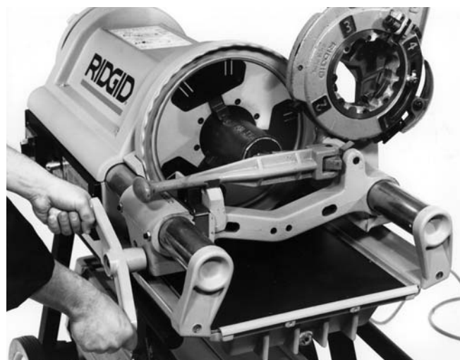
Figura 7 – Escariado de tubos con la Escariadora No. 744
