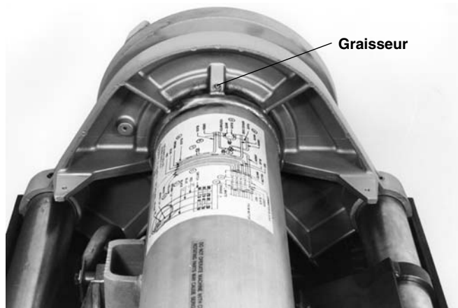
Figure 25 – Graissage des paliers principaux de l'arbre
