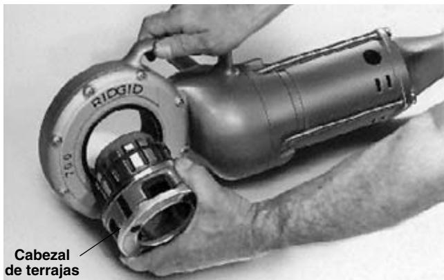
Figura 3 – Instalación del Cabezal de terrajas No. 12-R
