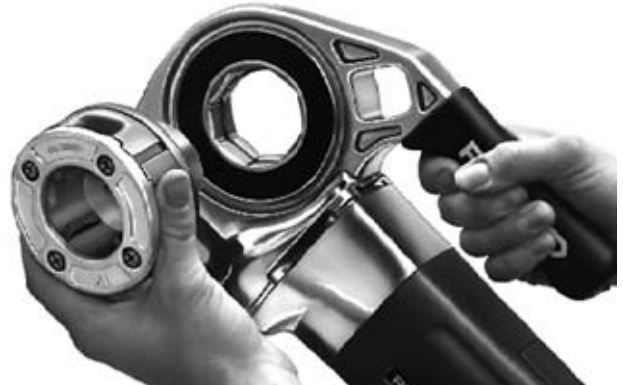
Figure 2 – Installation de la tête de filière orientable n° 11-R
