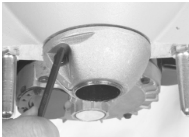
Figure 14 – Elimination du jeu de l'embrayage
