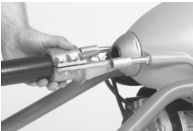
Figura 3 – Acoplamiento de la manguera guía trasera
