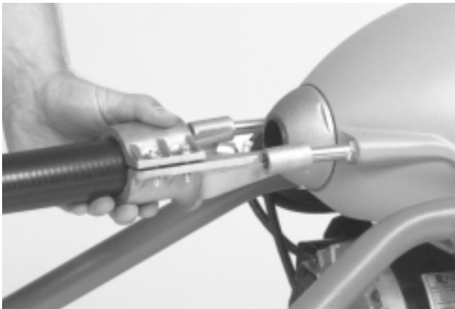
Figure 3 – Montage du guide-câble arrière
