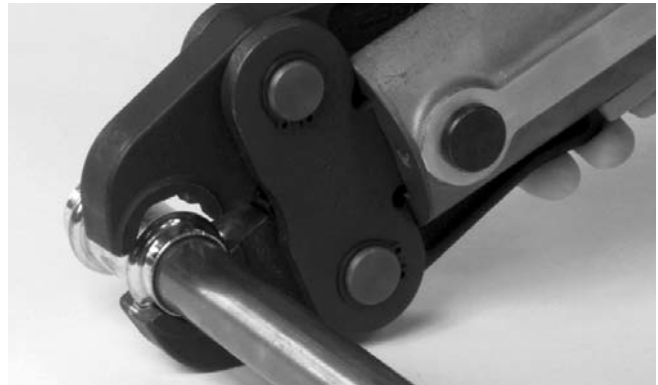
Figura 11 – Mordazas rodeando el acoplamiento
