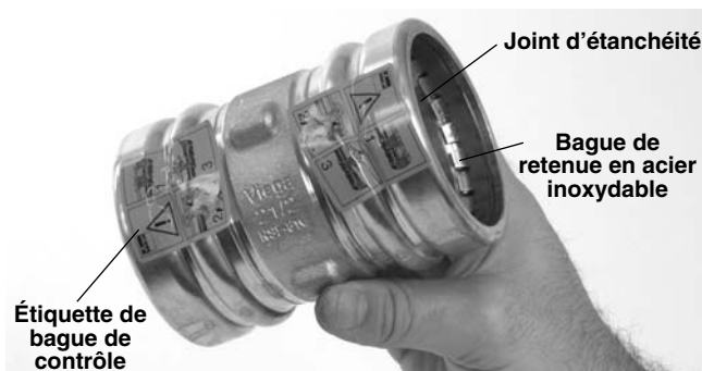
Figure 7B – Inspection d'un raccord ProPress XL avant insertion du tuyau
