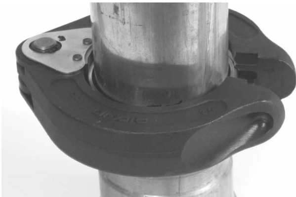
Figura 13B – Montaje del ProPress XL-C alrededor del acoplamiento
