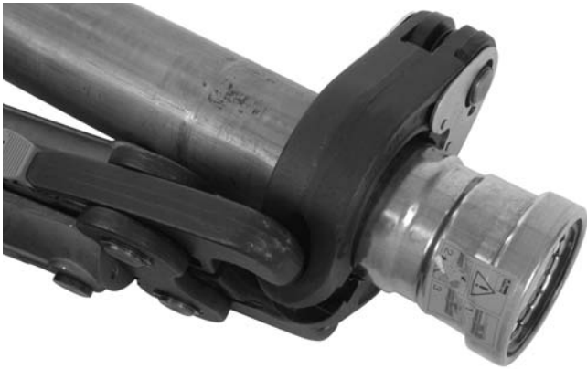
Figura 14C – Las puntas del accionador V2 colocadas, paralelamente al tubo, en las cavidades del aro XL-C para mayor maniobrabilidad
