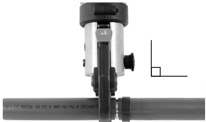
Figure 2 – Mâchoires perpendiculaires au tuyau et raccord
