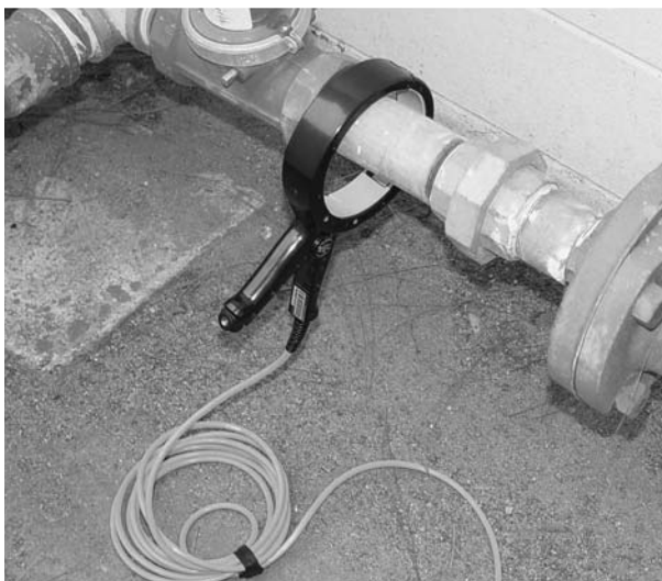
Figura 4 – Una manera de acoplar la pinza inductiva
