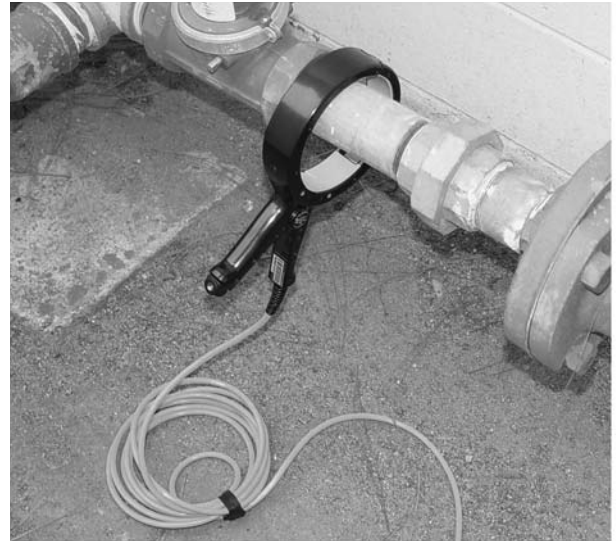
Figure 4 – Exemple de positionnement de la pince à induction
